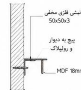
دیتیل اتصال به دیوار Sc:1/5
